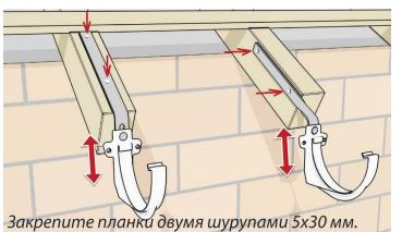
**3** Для монтажа водостока к стропильным ногам используйте горизонтальную и вертикальную металлические планки.
