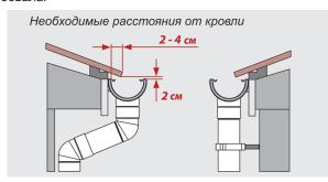
Элемент кровельной конструкции не должен перекрывать водосточный желоб более чем на 4 см.
