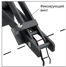
Произведите загиб одного крюка в соответствии с углом наклона кровельного ската при помощи устройства для гибки крюков, совместив разметку линии загиба с осью устройства. Примерьте к кровельному скату, в случае необходимости произведите дуги. Установите готовый крюк обратно в устройство для гибки, опустите рукоятку и закрутите фиксирующий винт до упора, чтобы определить угол загиба для остальных крюков. Произведите загиб оставшихся крюков при помощи устройства для гибки.
