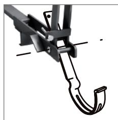
Для обеспечения движения воды по желобу в сторону стояка необходим уклон желоба 2,5 мм на погонный метр. Если рассмотреть желоб длиной 10 м, то уклон между первым и последним крюком будет составлять 2,5 см ( $10 \times 0,0025 = 0,025$  м (h)). В случае, если по одному кровельному скату два водосточных стояка, желоба устанавливаются с наклоном от середины расстояния между трубами.
